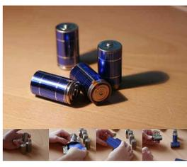
친환경 건전지라는 수식어가 부끄럽지 않은 태양광 충전 건전지 'SunCat'. 햇빛만 있으면 충전해서 쓸 수 있는 건전지이다. 노르웨이 발명가가 크누트 칼슨이 만든 SunCat이라는 태양광 충전 건전지는 일반 건전지와 똑같이 사용할 수 있으며, 단지 충전을 할 때 전기 콘센트에 꽂지 않고 햇빛으로 충전하는 것만 다르다고 한다.
