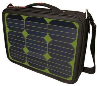
Voltaic사의 태양광에너지발전 노트북가방은 외부에 태양전지판이 부착되어 있고 내부배터리가 장착되어있어 햇빛이 충분하면 언제든지 전력을 생산하여 내부의 배터리에 담아둘 수 있다. 노트북가방의 소재는 간단하고 방수기능의 재활용된 PET으로 만들어졌으며 5시간의 충전으로 15와트의 전력을 생산할 수 있다. 자사의 이전 버전들에 비해 충전시간이 단축되었다는 장점이 있다. 우리나라의 바람을 이용한 충전기와 마찬가지로 가방으로 사용하면서 전자제품을 비용 없이 사용할 수 있게 하는 장치이다. 좀 더 디자인이 개선되고 에너지 효율이 높은 제품이 생산된다면 동급의 격인 499달러는 그리 높은 가격이 아니며, 따라서 향후 시장성이 높은 제품이라고 할 수 있다.
