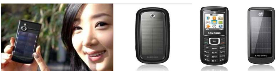
MWC 2009에서 삼성과 LG에서 태양광으로 배터리를 충전할 수 있는 단말기의 시제품을 공개했다. 각 사의 제품들은 휴대전화 후면 건전지 덮개에 태양광 패널이 장착되어 있어, 햇빛을 쬐기만 해도 배터리가 충전된다. LG는 *에코 프렌들리 폰*이라는 이름으로 삼성은 *블루 어스*라는 이름으로 출시 예정이며, 소재와 생산과정, UI, 패키지 등도 친환경 컨셉을 유지한다. 아직 태양광 배터리 10분충전에 3분의 음성통화를 지원하는 수준이지만, 시간이 갈 수록 점점 발전하게 될 전망이다.
